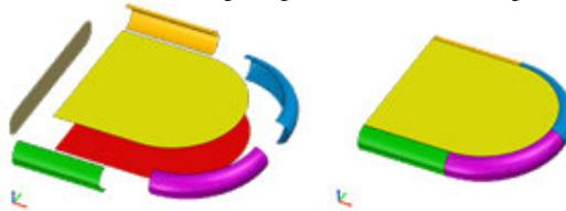
Рис. 3.4 BREP-представление простых твердых тел.
